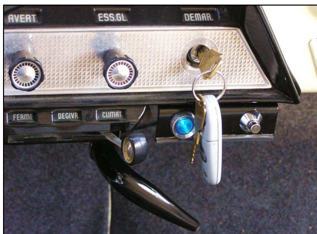
Un voyant bleu signale efficacement l'action de l'overdrive.
