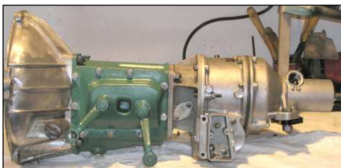
La boîte de Simca Vedette accouplée à l'overdrive du système Rushmatic.
