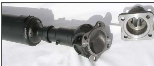
La nouvelle transmission et la bride de centrage rectifiée, côté OD.
