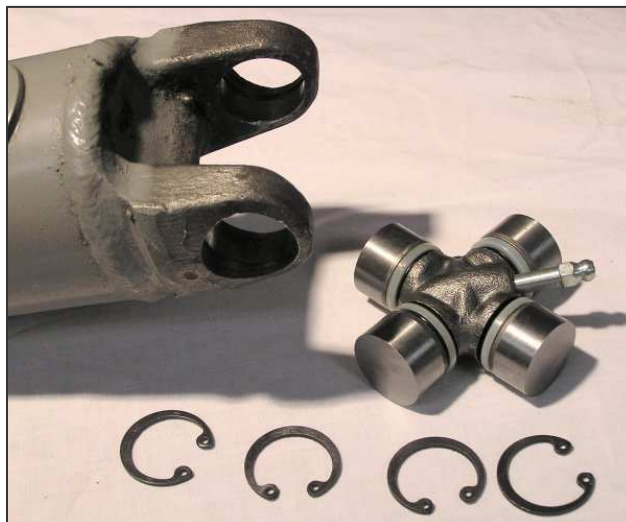
Détail de la réfection d'un des croisillons de la transmission.
