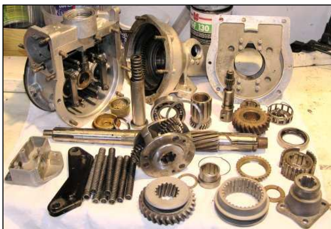
L'overdrive en pièces détachée et l'arbre de liaison au centre.
