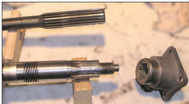
En haut la sortie de la boîte à l'origine. En bas, la sortie de l'OD et sa bride.
